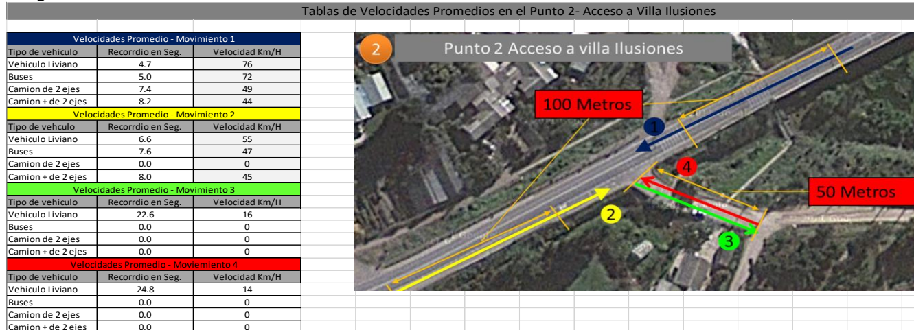
Figura N° 9: Síntesis de resultados de medición de velocidad Acceso Villa Las Ilusiones con Ruta 64
